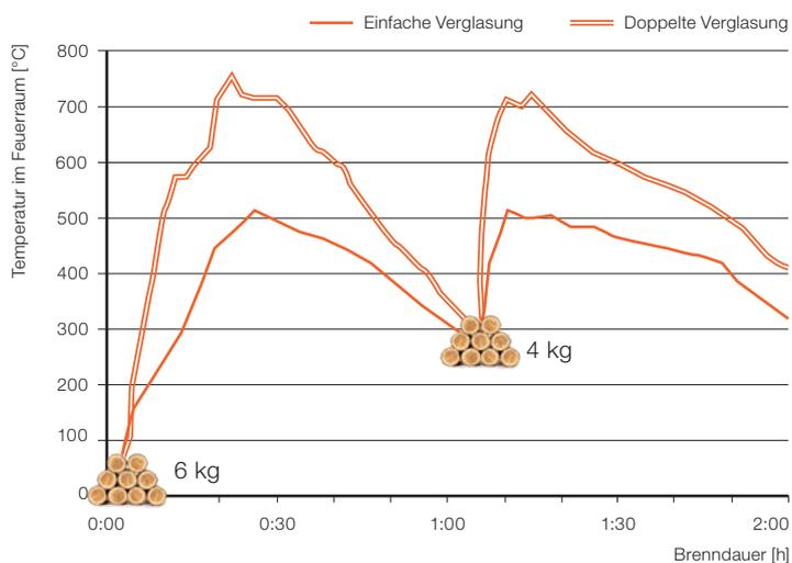
\* Die angeführten Werte wurden bei dem Model ECKA 67/45/51W bei einer Anwendung von 6 kg + 4 kg Holz gemessen.
