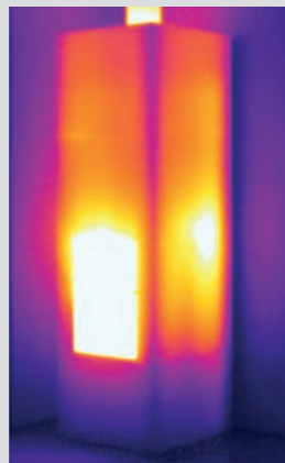
3 hod. od zatopení Průměrná teplota povrchu 88 °C
