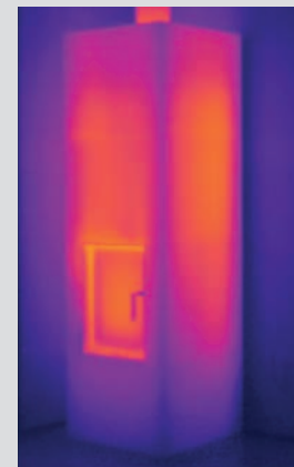
12 hod. od zatopení Průměrná teplota povrchu 45 °C
