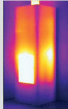
3 uur na verwarming Gemiddelde oppervlaktemperatuur 88 °C
