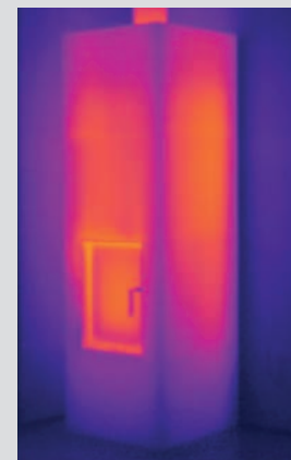
12 godz. po rozpaleniu Średnia temperatura powierzchni 45 °C
