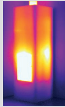
3 uur na verwarming Gemiddelde oppervlaktemperatuur 88 °C
