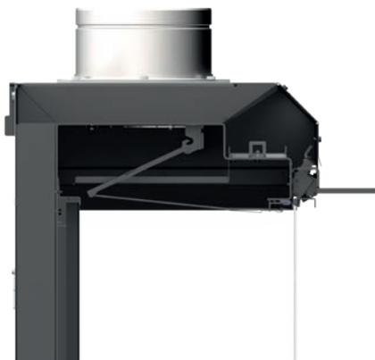
Position de la vitre frontale et du clapet de surpression
